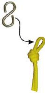
Reposicione os ganchos que estão acoplados as extremidades das cordas dos balanços para a posição central indicada.
