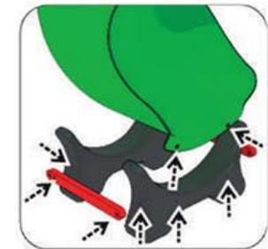
Encaixe uma das bases na parte frontal do túnel escorregador e parafuse. Posicione a segunda base e parafuse as travessas para unir as duas peças.
