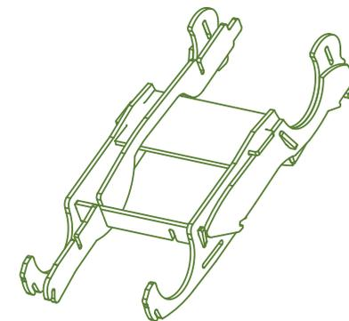
Encaixe a haste por baixo do eixo. A parte colorida ficará para fora.
