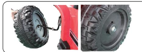
Instalação das rodas dianteiras: insira a roda dianteira no eixo dianteiro e prenda com a rosca.
