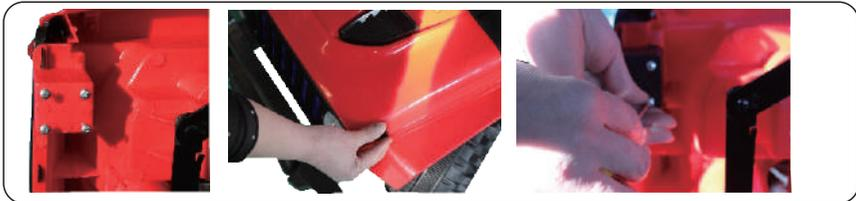
Instalação do para-choque: aparafuse o para-choque ao corpo do carro abaixo do parafuso sextavado.
