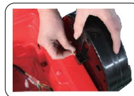
Instalação do porta-malas: inserir o parafuso no meio da parte traseira do porta-malas.
