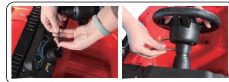
Instalação da direção: conecte a direção à barra de direção e aparafuse no orifício geral da inserção do parafuso.
