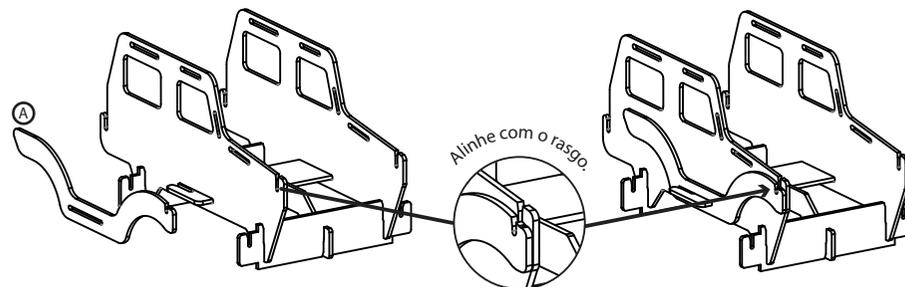
06 - Encaixe a peça "B" no gancho lateral e deslize levemente para frente para encaixar.
