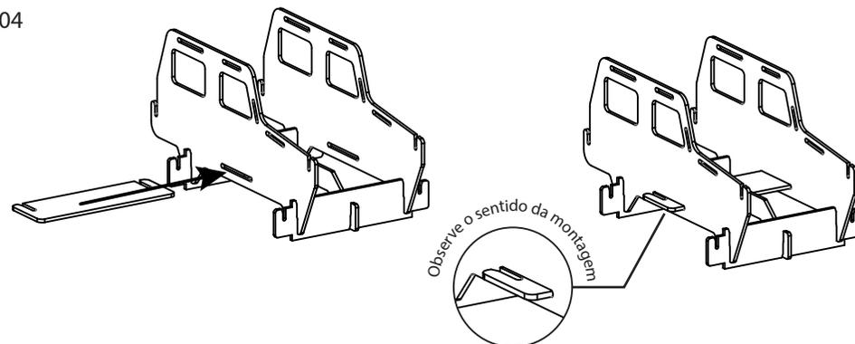
05 - Encaixe a peça "A" conforme a ilustração, alinhe a frente da peça com o rasgo da lateral.
