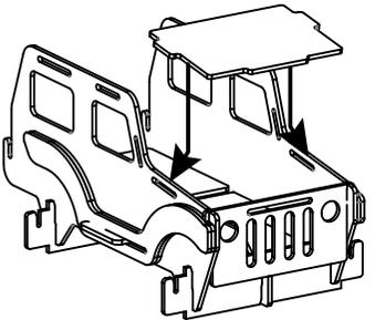
Para facilitar a montagem faça o encaixe inclinando a peça:
